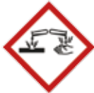
Danger de corrosion
